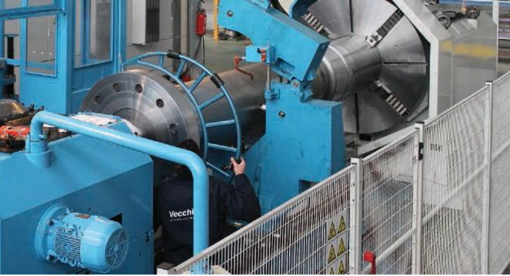
Горизонтальный токарный станок Tacchi оснащён фрезерующим устройством на головке. Tacchi horizontal lathe equipped with milling device.
