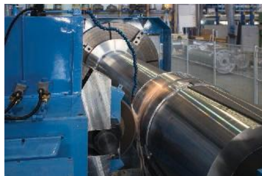
Горизонтальный токарный станок Innse оснащён шлифовальным устройством. Innse horizontal lathe equipped with grinding device.
