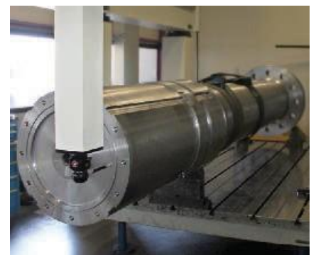
Горизонтальный токарный станок Innse оснащён шлифовальным устройством. Innse horizontal lathe equipped with grinding device.
