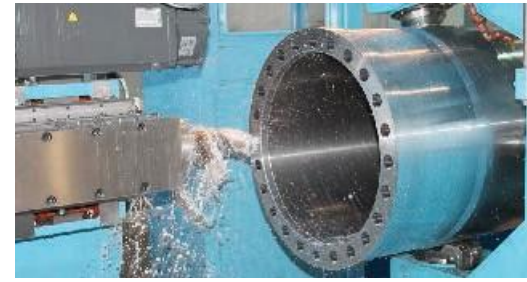
Горизонтальный токарный станок Tacchi оснащён фрезерующим устройством на головке. Tacchi horizontal lathe equipped with milling device.
