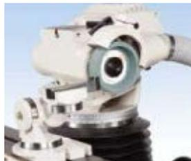
Данное приспособление позволяет надежно зажать резец и заточить передний и задний углы режущей части.
