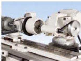
В основном используется с механизмом цилиндрического шлифования. Может быть использован для шлифования внутренних конусов. Внутренний шпиндель – 20000 об/мин. Длина отверстия до 40 мм или 75 мм. Диапазон размеров отверстия для шлифовки 8–20 мм, 12–50 мм.
