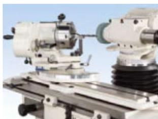
Эта головка была разработана для достижения легкой, эффективной и точной переточки при минимальной затрате сил. Сверло закреплено на спиральном патроне с шестью захватами, приводится в движение эксплуатационным рычагом.
