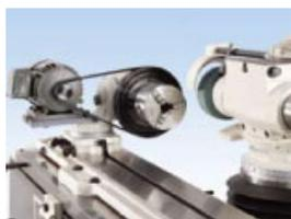
Данное устройство подходит для прямого или конусного цилиндрического шлифования и для торцевого шлифования различных инструментов.
