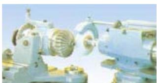
Предназначена для формирования углового радиуса на торцевых, цилиндрических и концевых фреззах. Чтобы избежать ошибки, позиционирование круга производится при помощи микрометра.
