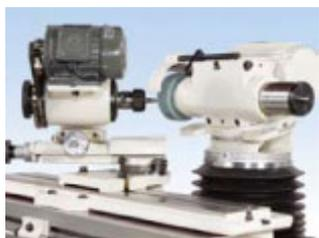
Идеально для шлифования радиуса сферических концевых фрез. Состоит из платформы с двумя направляющими, каждая из которых имеет микрометрическую регулировку и головку с конусом Морзе №5 или конусом Морзе №12. Поворот на заданный угол фрез с прямолинейными канавками возможен с использованием делительного диска, установленного на задней части рабочей головы.
