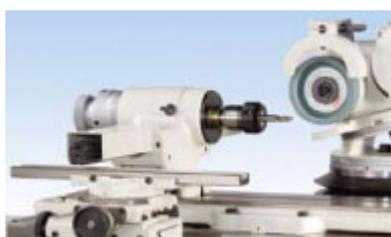
Этот приспособление подходит для шлифования задних и передних углов режущей кромки фрез со спиральным зубом и прямозубых червячных фрез, торцевых фрез и центровочных сверл.
