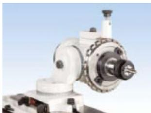
Точная индексация достигается быстро и легко путем установки функции индексирующего шлифования на стандартной головке.
