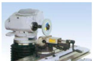
Его также называют «Универсальными поворотными тисками». Оно состоит из поворотных тисков и независимого суппорта, размещенного между тисками и основанием. Промежуточный суппорт позволяет тискам поворачиваться на 360° горизонтально и вертикально, так что деталь можно легко установить. Ширина тисков – 100 мм. Высота тисков – 25 мм. Раскрыв – 70 мм.
